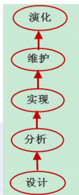
图 1-2 采用喷泉模型的软件过程
