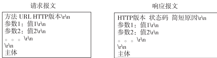
图 2-3 HTTP 报文结构
