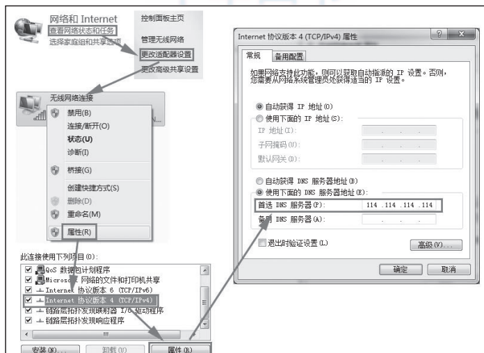
图 3-2 Windows 7 设置 DNS 服务器
